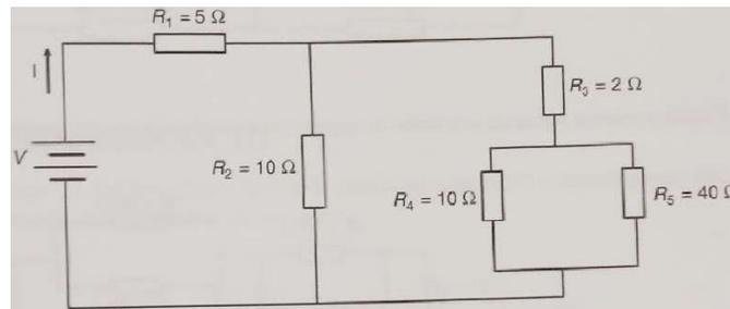
12 – Determine as correntes e as tensões em todos os resistores do seguinte circuito:
