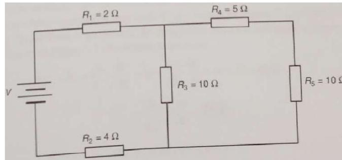
14- Se  $V_7=20V$ , determine a tensão  $V$  aplicada pela fonte.
