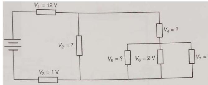
11 – No circuito a seguir, são dadas  $I = 20A$  e  $I_3 = 10A$ . Determine as demais correntes e tensões nos resistores.
