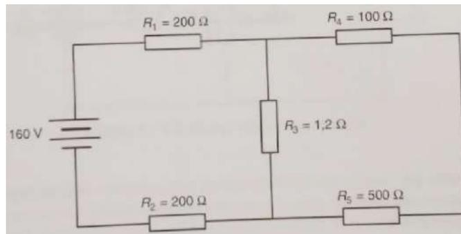
13 – Se  $I_5 = 2A$ , determine o valor da tensão aplicada  $V$  e a potência fornecida pela fonte:
